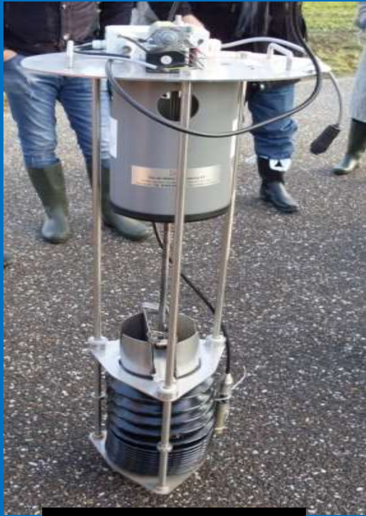
جهاز تحكم في تصريف المياه الارضية
